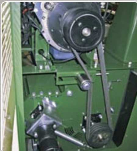
Trasmissione con frizione per versione diesel Transmission with clutch for diesel version Transmission avec embrayage pour version diesel Transmisión con embrague para versión diesel Getriebe mit Kupplung für die Diesel Ausführung Overbrenging met koppeling voor de diesel versie
