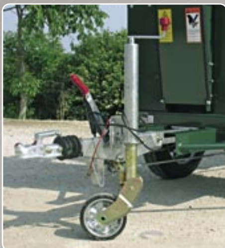
Carrello omologato per traino su strada 80 km/h 80 km/h trailer for road transport Remorque homologuée à 80 km/h pour le transport sur route Carrito para el transporte en carretera con remolque de 80 km/h 80 km/h Fahrwerk für Straßenverkehr Gehomologeerde aanhanger voor wegverkeer tot 80 km/u
